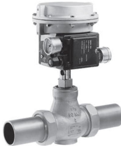
Pneumatisk reguleringsventil Type 3222/2780-2 med positioner Type 3760 (Type 3222 med svejseender)
